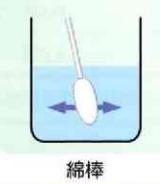
容器壁に押しつけながら回転させて十分に洗い落とす
